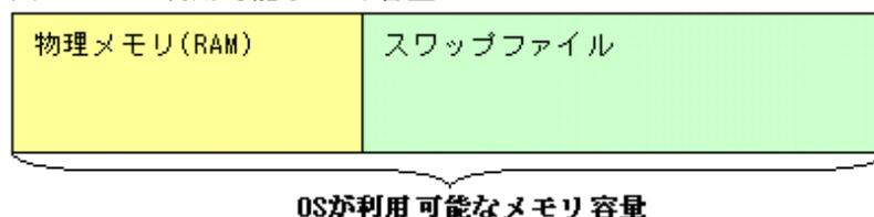
ただし、ハードディスクへのアクセスはRAMより低速なので、メモリのスワッピングは性能に大きく影響を与えますので、注意が必要になります。
