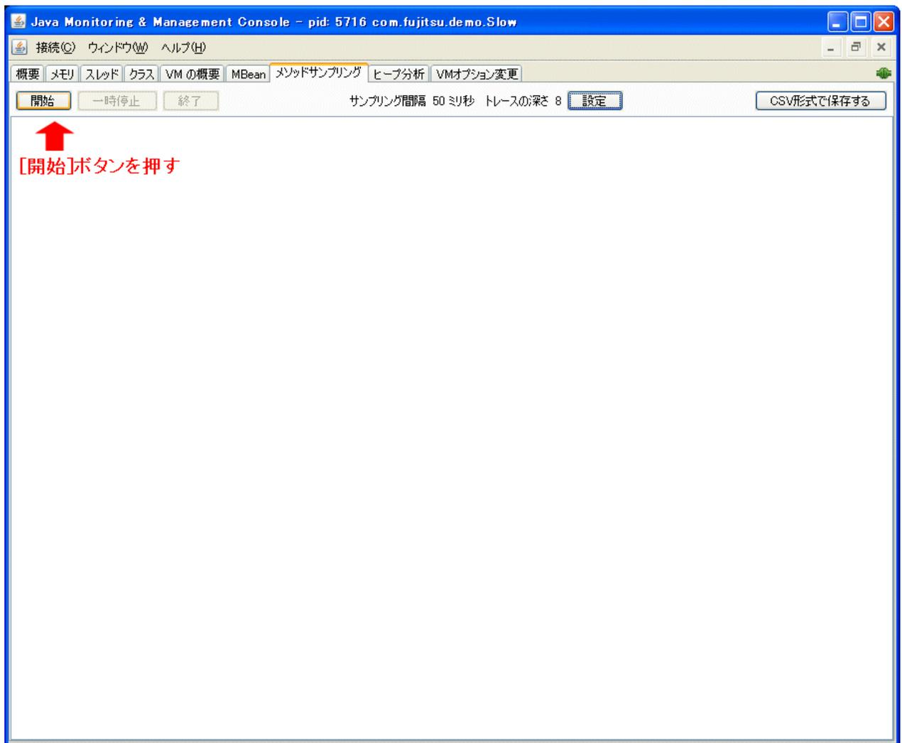
図 9 Java監視機能による、メソッドサンプリングの開始方法
