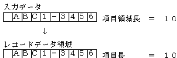
図2 英数字項目での編集格納の例
