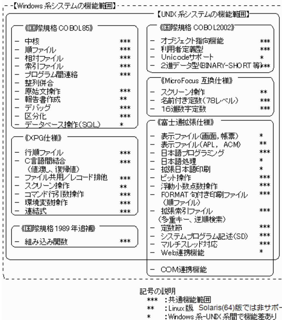
図5.1 UNIX系システムとWindows系システムの機能範囲
